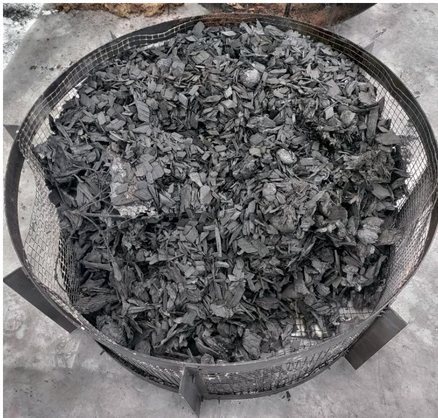
Kuva 9. Hakkeesta, männynkuoresta, jätevedenpuhdistamolietteestä ja biojätteestä pyrolysoitua biohiiltä.
